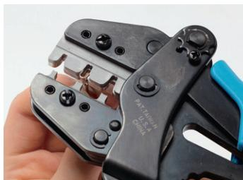
② 圧着の際はダイス端面に絶縁圧着部後端を合せる。
