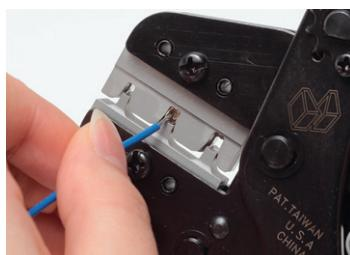
④ 予め被覆を剥いた電線を端子の芯線圧着部に挿入します。
