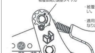
・適用電線サイズによっては被覆部の圧着状態が崩れて圧着される場合があります。
