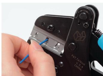
⑤ 被覆が芯線圧着部に当たる手前まで挿入し、電線被覆部をインスレーションパレルに出来るだけ押しす。
