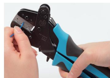
⑥ 電線が動かない様に保持し、ラチェットが開放されるまでハンドル握り込むと圧着は完了します。
