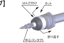
ケーブルの編組線をときほくしてクランプ上に折返し、クランプのつばよりはみ出た編組線はカットする。ケーブルを折り返し後寸法にカットし、中心コンタクトをはんだ付けする。
