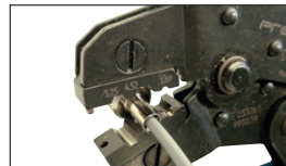
⑤組み上がったケーブルをコネクタ本体に差し込み、フェルルールが本体内部に入っていることを確認し、圧着工具にて圧着する。
