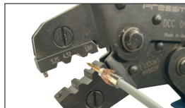
④ケーブルの導体に中心コンタクトを差し込み、ケーブルのスペーサ寄りにて圧着工具にて圧着する。
