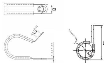
※固定夹上的橡胶部分可拆卸
