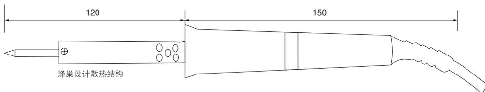
蜂巢设计散热结构
