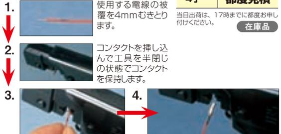
電線をコンタクトの奥に突きあたるまで挿し込んで工具が解除するまで閉じてください。
