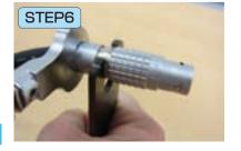
⑥ 2個のレンチを使用し、適正なトルク値(各商品ページ参照)でコレット ナットを締め付ける。
