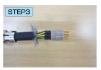
③ 各芯線に絶縁用の熱収縮チューブを通し、半田付けを行なう。半田付け後、熱収縮チューブを被せ、収縮させる。
