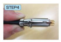
④ インシュレーターにインサートキャリアを取り付け、コレットを突き合わせ、はみ出したシールドを折り曲げ、切り揃える。
